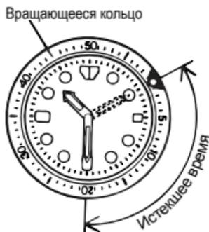
Кольцо не может поворачиваться в противоположном направлении, поскольку оно оснащено защитным механизмом, предназначенным для защиты от ошибочной операции в результате приложения силы или удара. Цифры на вращающемся кольце также могут упростить считывание текущего времени.
