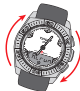
Поверните часы на горизонтальной поверхности (например, на столе) вокруг их оси больше чем на один полный оборот со скоростью вращения приблизительно 30° в секунду. Желательно, чтобы вокруг не было никаких магнитных полей. Общее время: 20 секунд максимум.
